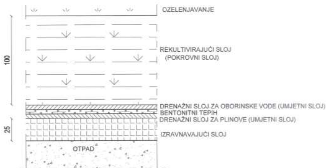
Slika 1.3/2 – Detalj završnog pokrovnog sloja
